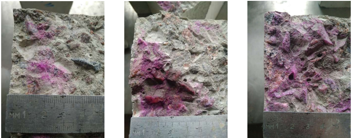
Рисунок 4.20 - Глибина карбонізації крупнозернистих бетонів К(а), ЦПК (б) та ЦПКПв (в) після 3 років зберігання у повітряному середовищі
