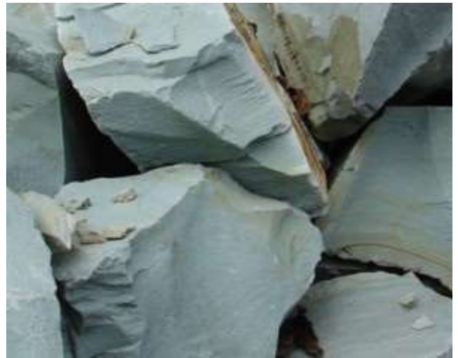
Рисунок 2.2 - Молекулярна будова цеоліту (а) та зовнішній вигляд цеолітового туфу (б)
