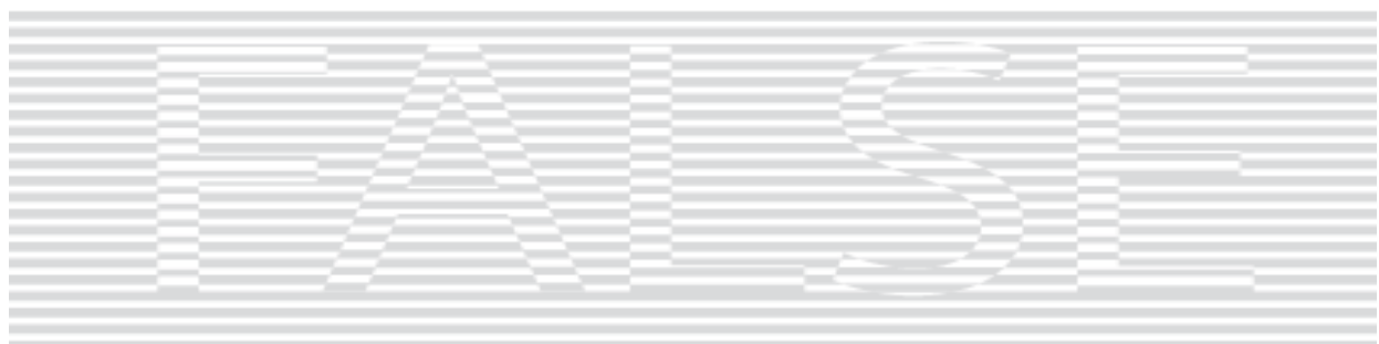
Рисунок 3.13. Допоміжний шар з прихованим написом, що утворений зміщенням ліній
