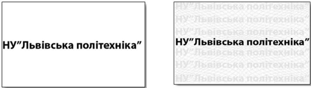
Рисунок 2.8. а) Вигляд захищеного документа; б) Скопійований вигляд документа з видимими латентними елементами
