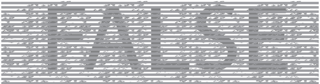
Рисунок 3.16. Основний шар з фрактальною сіткою, яка зміщена на лінію растру
