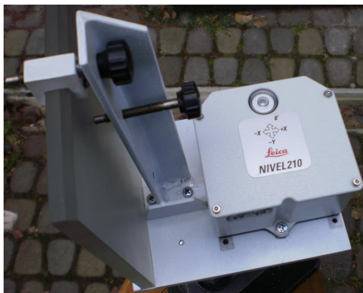
Рис. 3.24 Вид зверху дзеркального компенсатора з виправними гвинтами дзеркального відбивача
