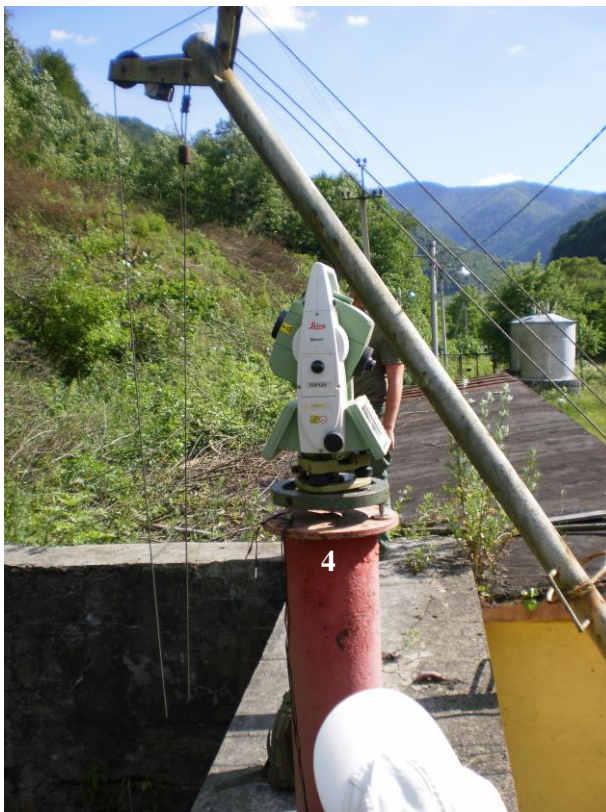
Рис. 4.20 Роботизований тахеометр TCRP-1201 на пункті 4
