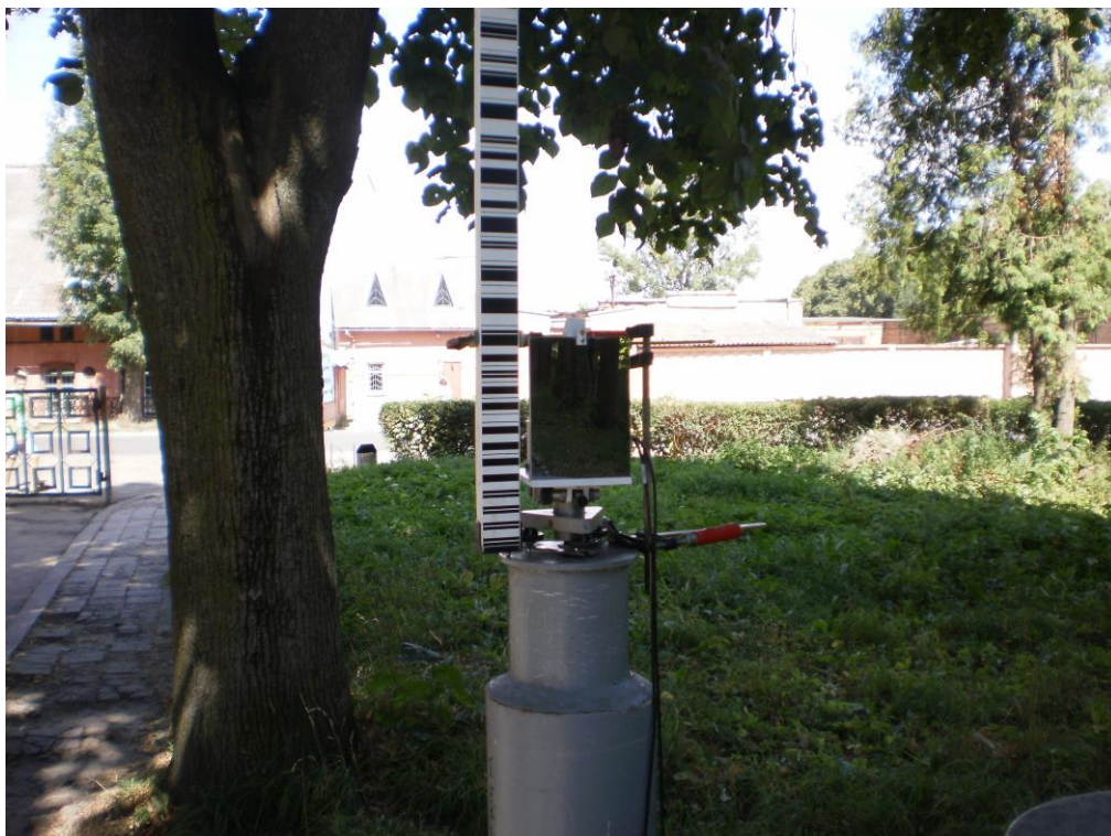
Рис. 3.27 Установлений нівелір-рефрактометр на початковому трубному пункті №1 експериментальному базису
