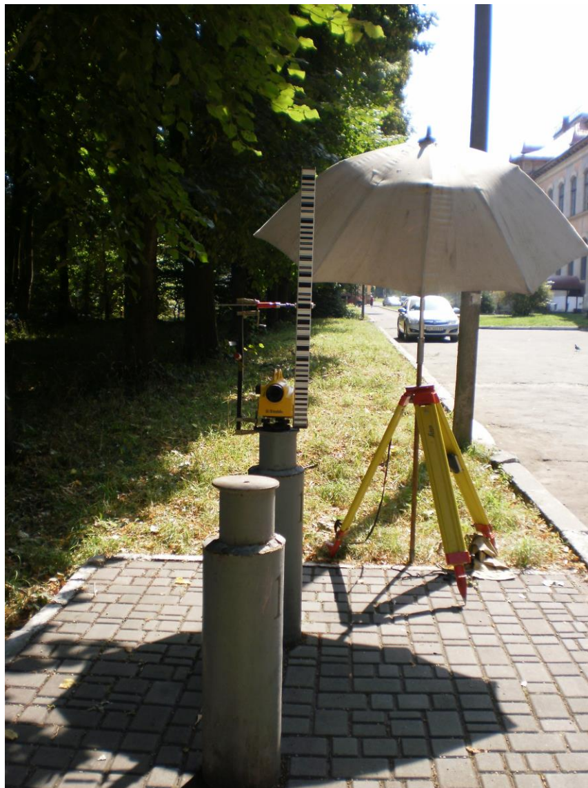
Рис. 3.26 Установлений нівелір Dini 03 на трубному пункті експериментального базису №15
