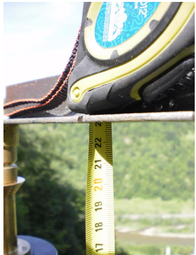
Рис. 4.21 Фото відлічування пристрою для вимірювання висоти підставки
