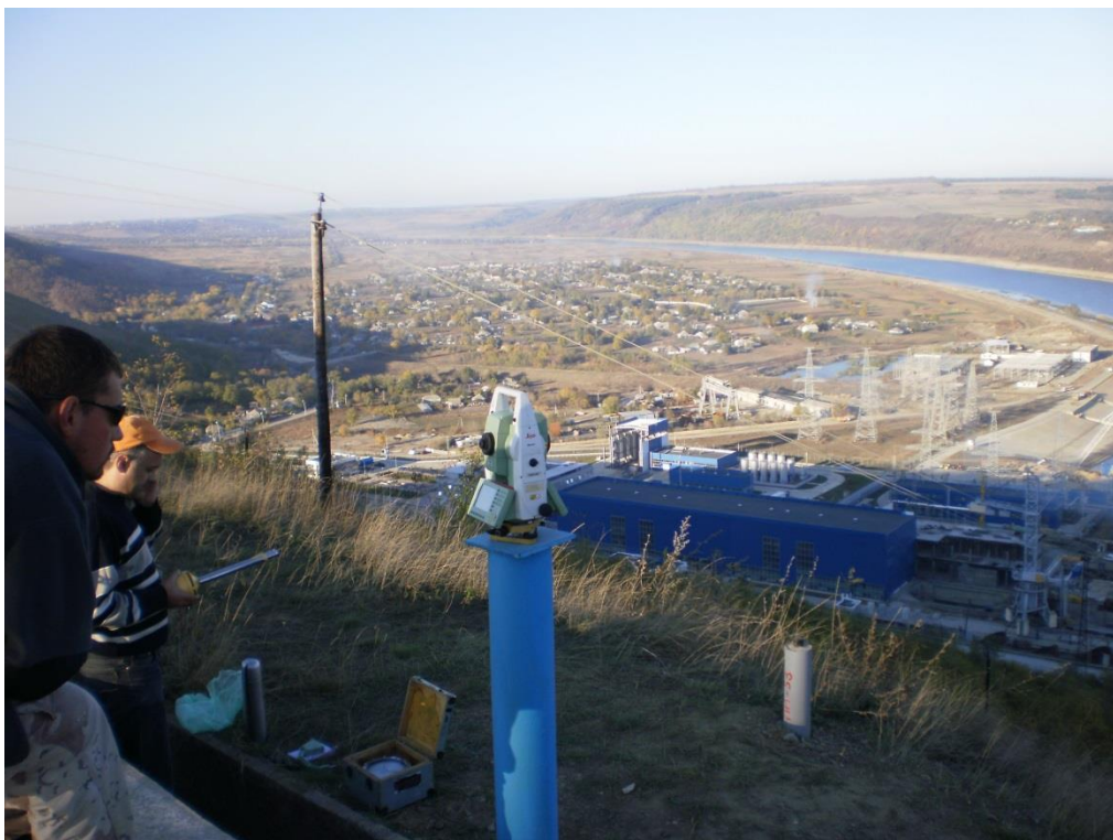
Рис. 4.9 Спостереження TCRP-1201 на пункті “Створний”
