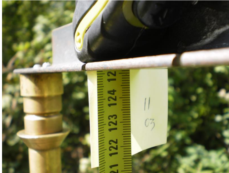
Рис. 2.10 Вимірювання висот тахеометра та відбивачів із застосуванням спеціального пристрою та фотофіксації результатів
