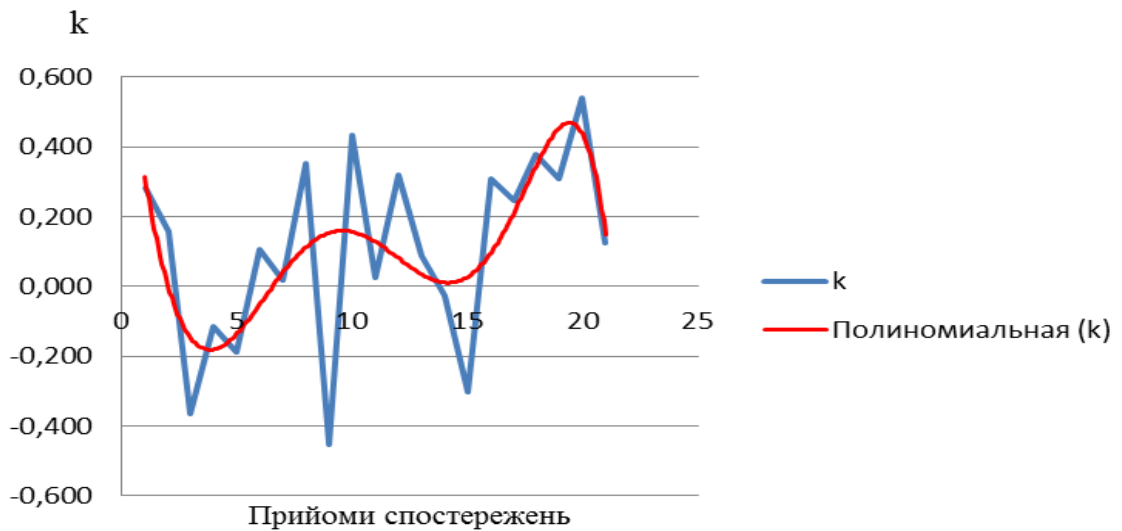
Рис. 3.31 Зміна коефіцієнта вертикальної рефракції k під час безперервних спостережень
