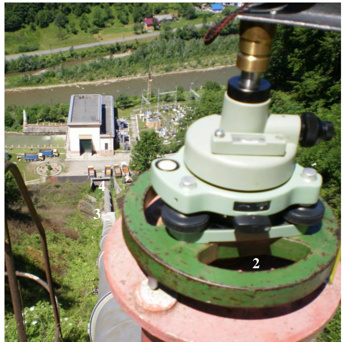
Рис. 4.17 Пункт спостереження 2. Установлення пристрою для вимірювання висоти відбивача
