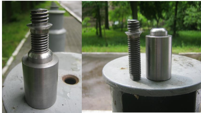
Рис. 4.10 Становий гвинт для примусового центрування приладів і відбивачів на трубних знаках
