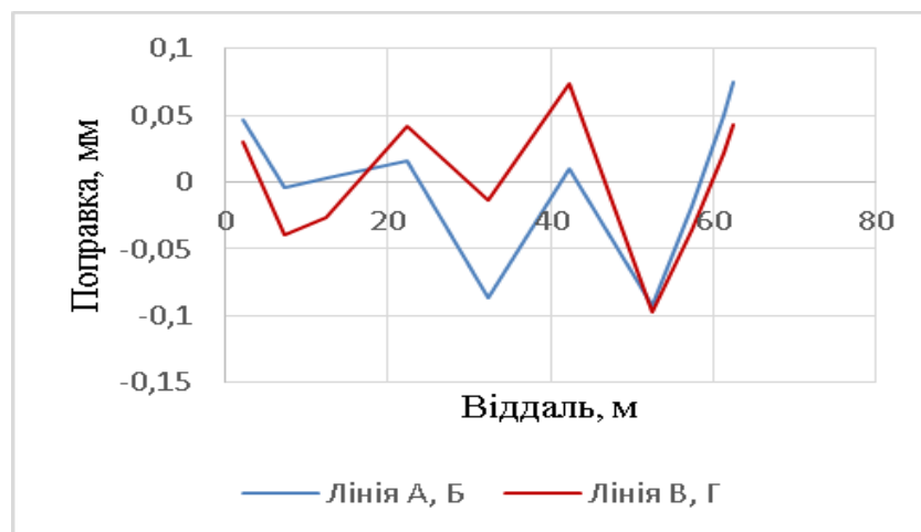
Рис. 3.14 Залежність лінійної величини похибки перефокусування від віддалі для DNA 03
