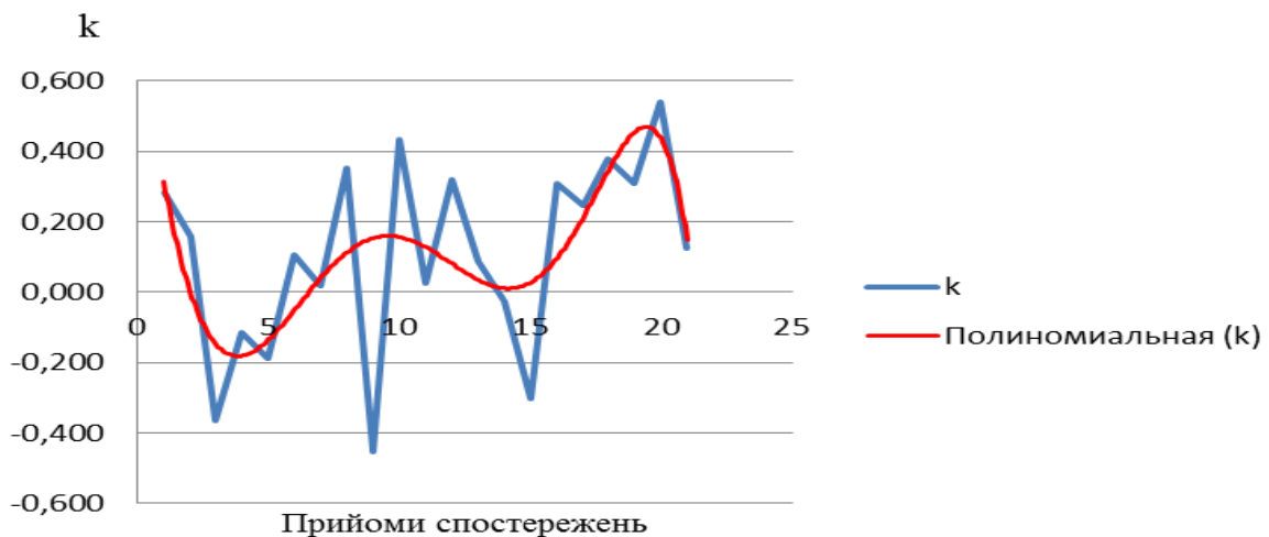
Рис. 10 Зміна коефіцієнта вертикальної рефракції під час періоду безперервних спостережень (22 прийоми)
