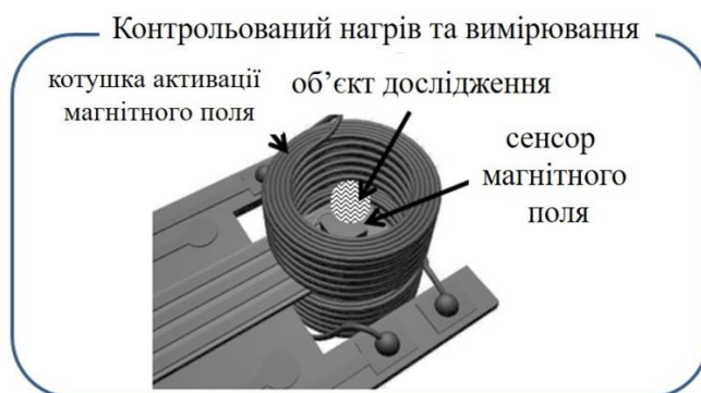
Рис. 3.5. Функціонально інтегрований термомагнітний вимірювальний перетворювач
