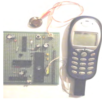
Рис. 6.11. Фотографія вимірювальної системи діагностики магістральних трубопроводів
