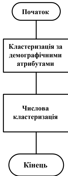
Рис. 4. Структурна схема двоетапного методу категоріально-числової кластеризації
