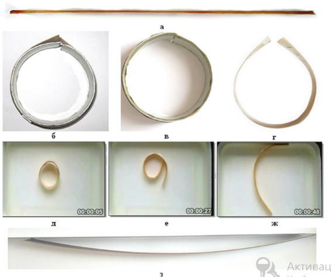
Рисунок А. 3 – Зміна форми зразка шпону та ефект пам'яті деревини берези [199]: а. волога деревина; б. навантажена волога деревина; в. після сушки при навантаженні; г. після розвантаження сухої деревини; д. спочатку зволоження; е. через 27 сек. зволоження; ж. через 48 сек. зволоження; з. після зволоження і витримки.
