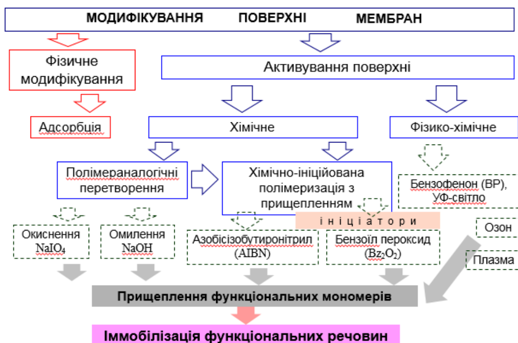
Рис. 5.1. Схема процесу поверхневого модифікування мембран
