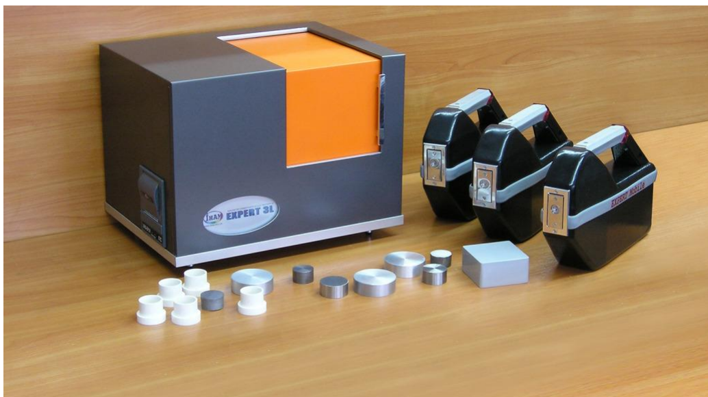
Рисунок – 2.1 Енергодисперсний рентгенофлуорисцентний аналізатор Expert 3L
