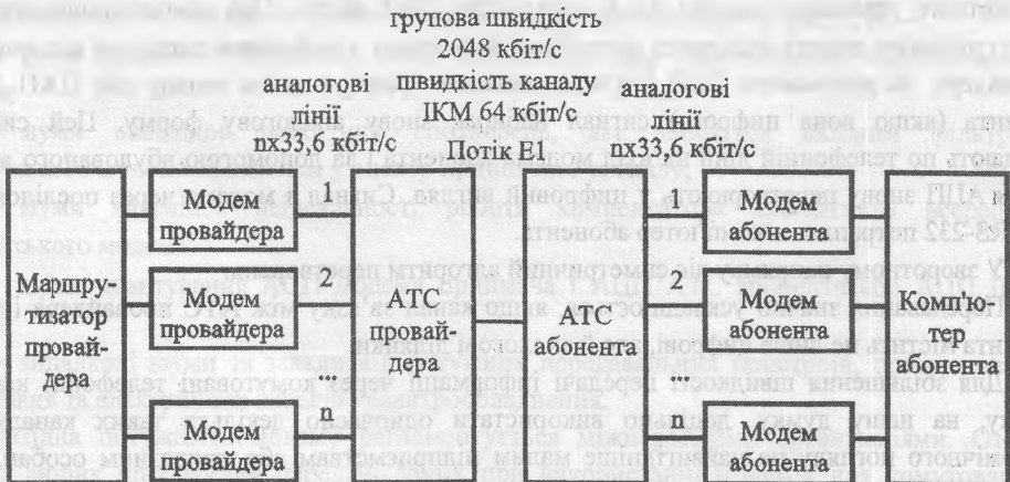
Рис. 3. Передавання сигналів між провайдером і абонентом при використанні n каналів зв'язку зі стандартними модемами та спеціального програмного забезпечення
