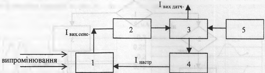
Рис. 6. Функціональна схема давача з мікропроцесорним керуванням:
