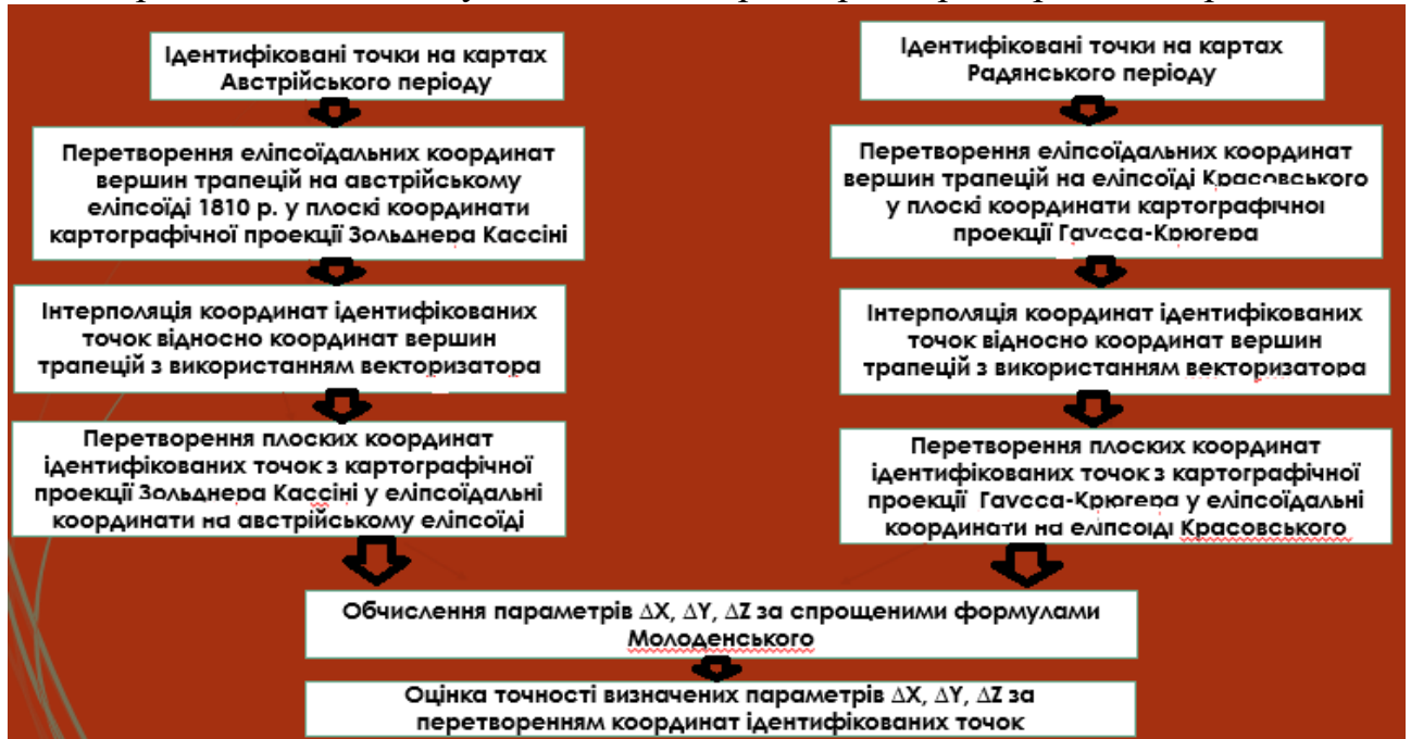
Рис. 4. Схема визначення параметрів перетворення координат
