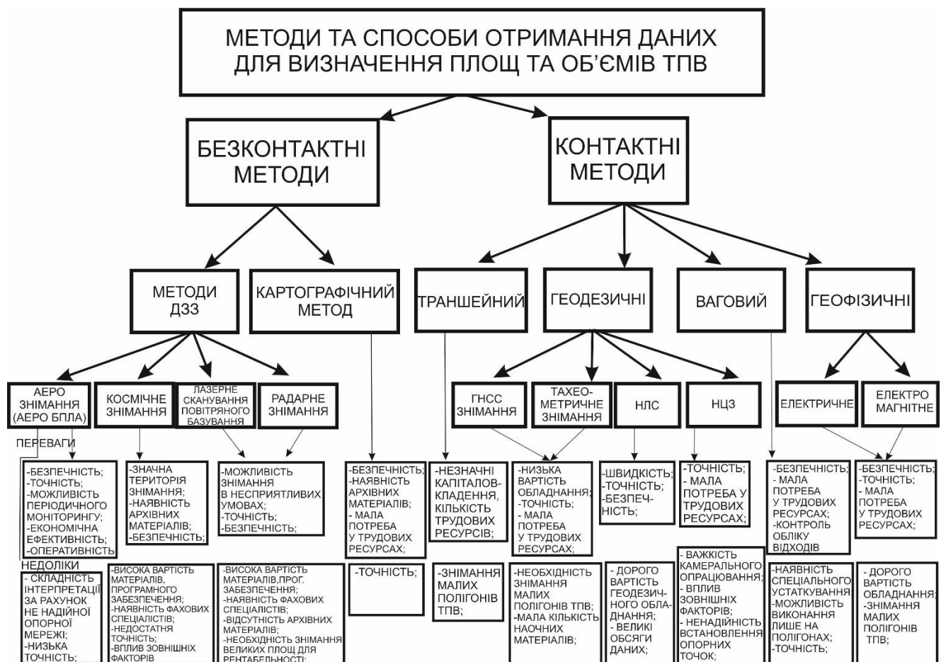
Рис. 1.10. Класифікація методів та способів отримання даних для визначення площ та об'ємів ТПВ
