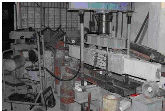
Рис. 4. Загальний вид підсиленої балки при випробуванні
