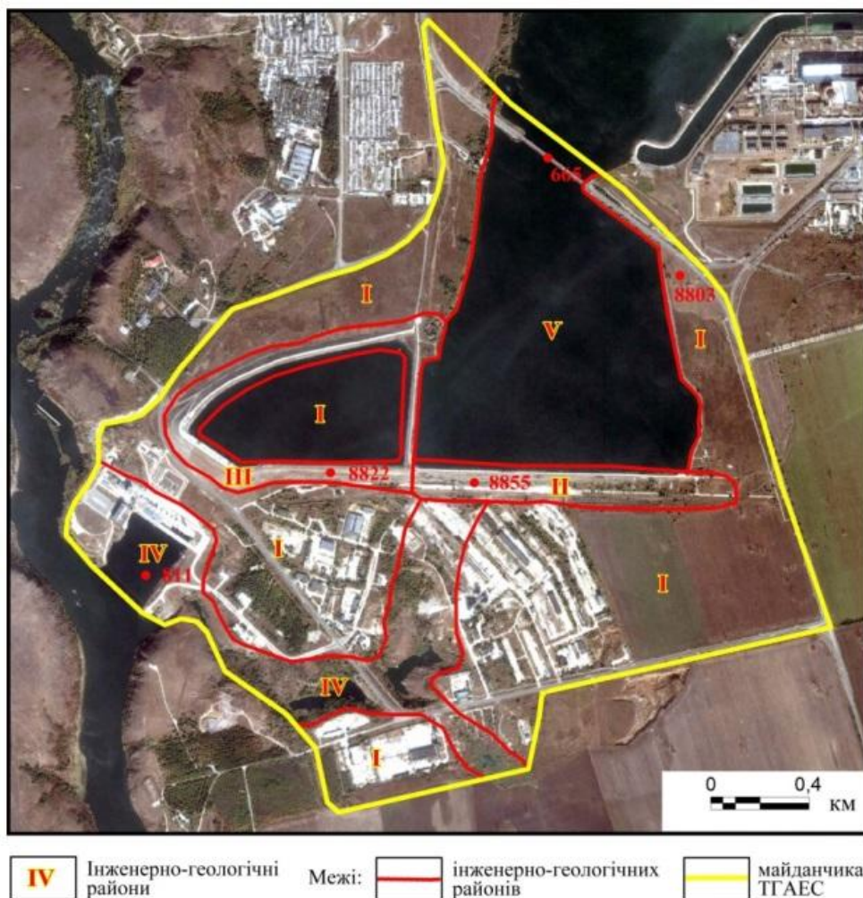
Рис. 1. Схема розташування ділянок на території Ташлицької гідроакумулювальної станції (ГАЕС), виділених за результатами її сейсмічного мікрорайонування (СМР) комплексом з трьох методів: методу сейсмо-геологічних аналогій, методом сейсмічних жорсткостей і методом реєстрації землетрусів, вибухів і короткоперіодних мікросейсм
