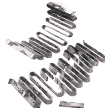
Рисунок 2 – Зруйнована змієподібна пружина
