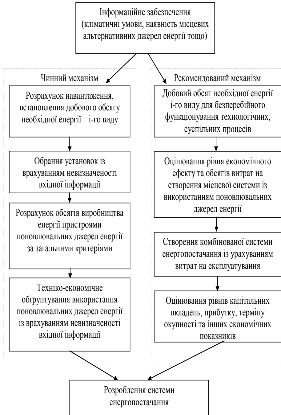
Рис. 4.18. Схема економічного обґрунтування варіантів використання поновлювальних джерел енергії в системі енергопостачання України
