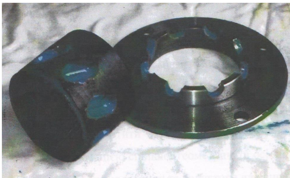
Рис. 4.7. Загальний вигляд веденої і ведучої напівмуфт, після їх припрацювання без мастила
