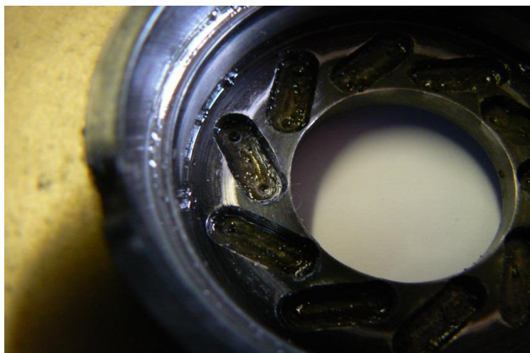
Рис. 2.3 Фрагмент ведучої напівмуфти після перевантажень
