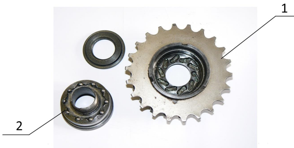
Рис. 2.2. Ведуча 1, ведена 2 напівмуфти (вигляд з торців)
