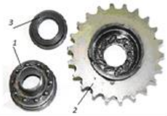
Рис. 2. Деталі кулькової муфти вільного ходу радіальної дії після перевантажень: а – фрагмент ведучої напівмуфти; б – ведуча і ведена напівмуфти 1 і 2 та гайка 3 зі слідами спрацювання робочих поверхонь
