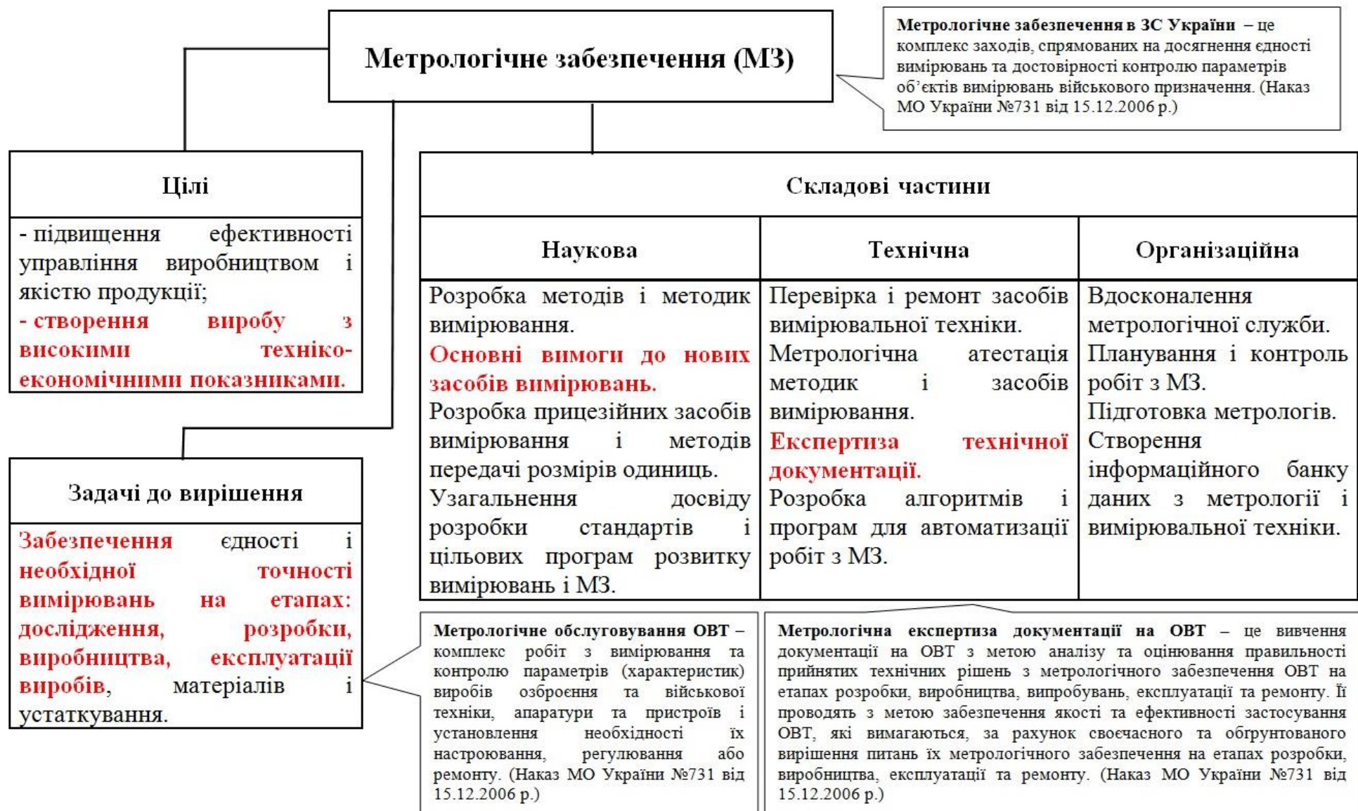
Рисунок 1.4 – Загальна структура метрологічного забезпечення вимірювань
