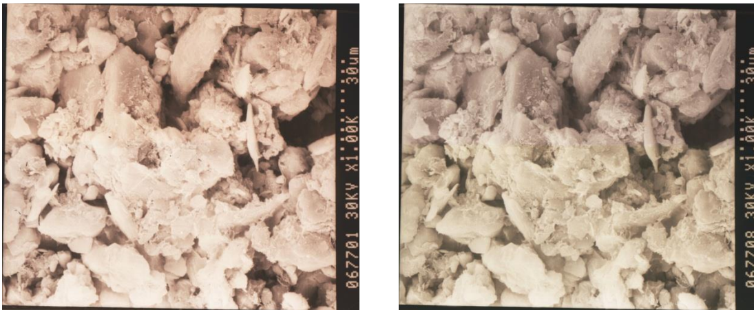
Рис. 5.6. Стереопара мікроповерхні лесового ґрунту, отримана на РЕМ «Hitachi» S-800 при M = 1000\times і кутах нахилу гоніометричного столика \alpha_{\text{п}} = 0^\circ , \alpha_{\text{п}} = +8^\circ .
