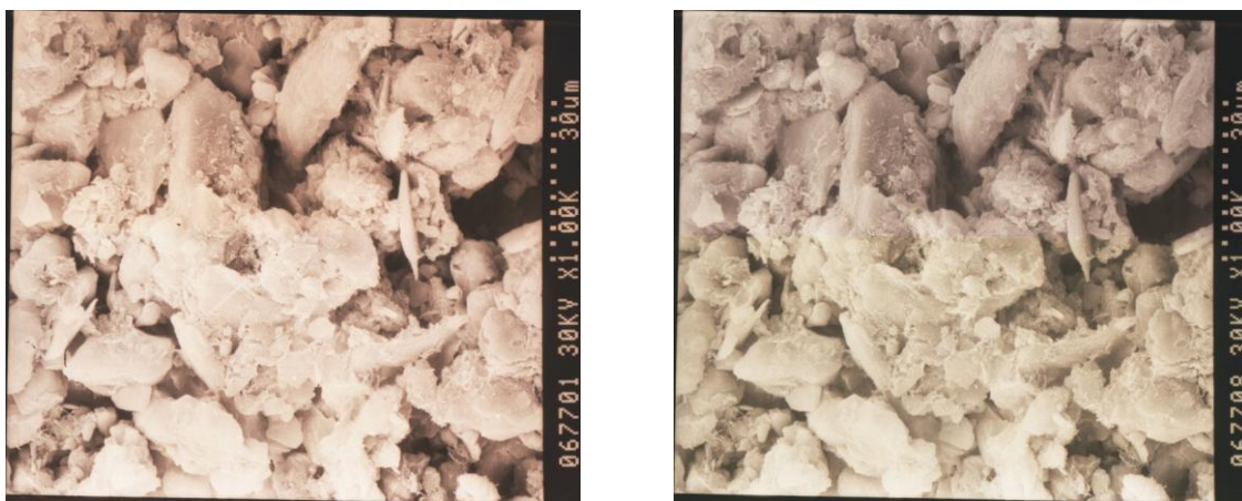
Рис. 4.1.І. Стереопара мікроповерхні лесового ґрунту, отримана на РЕМ «Hitachi» S-800 при M = 1000^x і кутах нахилу гоніометричного столика \alpha_{\text{п}} = 0^\circ , \alpha_{\text{п}} = +8^\circ .
