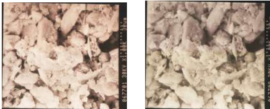
Рис. 4.1. Стереопара мікроповерхні лесового ґрунту, отримана на РЕМ «Hitachi» S-800 при M = 1000^x і кутах нахилу гоніометричного столика \alpha_n = 0^\circ , \alpha_n = +8^\circ
