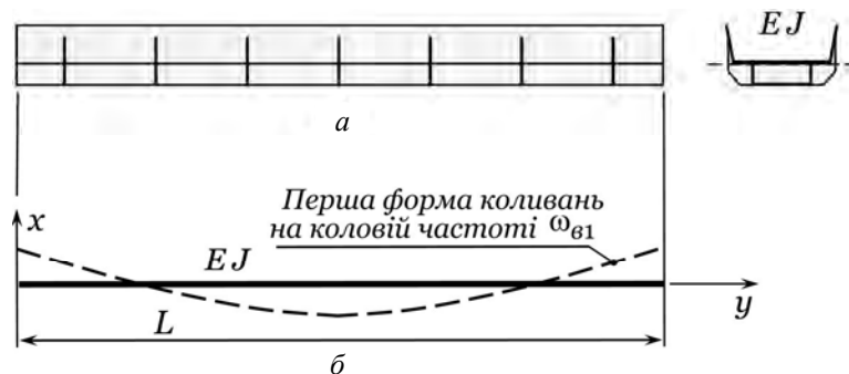
Рис. 4. Робочий орган вібраційного живильника у вигляді жолоба (а) завдовжки L = L_{\max} та його схема заміщення у вигляді балки з вільними кінцями (б)
