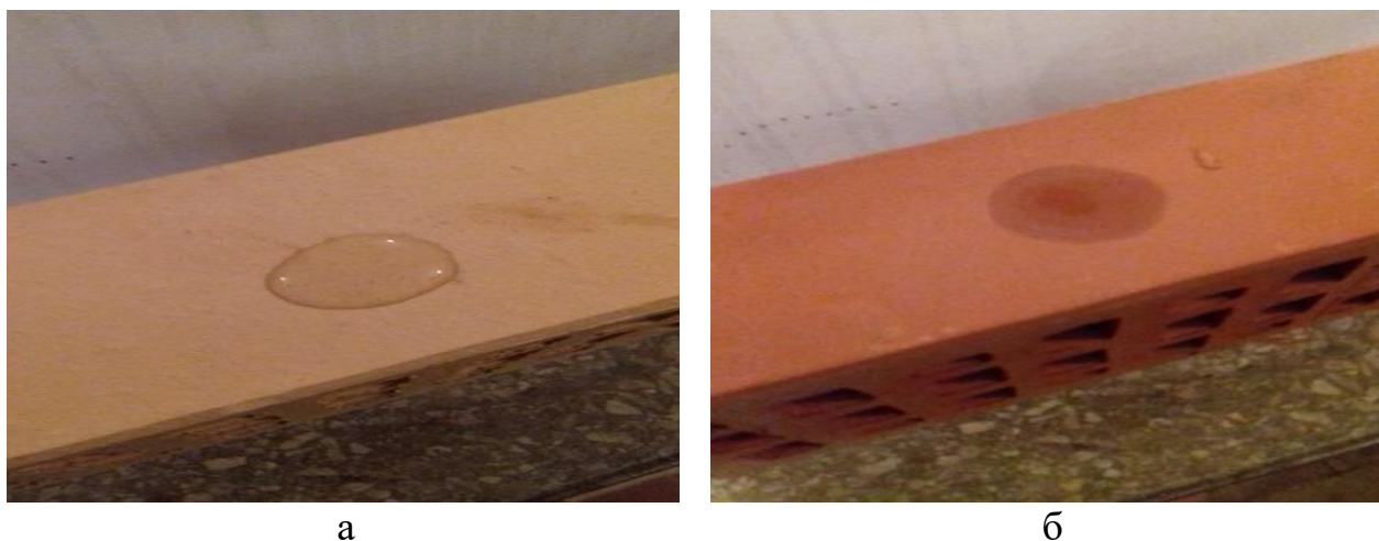
Рис. 3.8. Поверхневе краплинне поглинання води: а – керамічна клінкерна цегла; б – керамічна лицьова цегла
