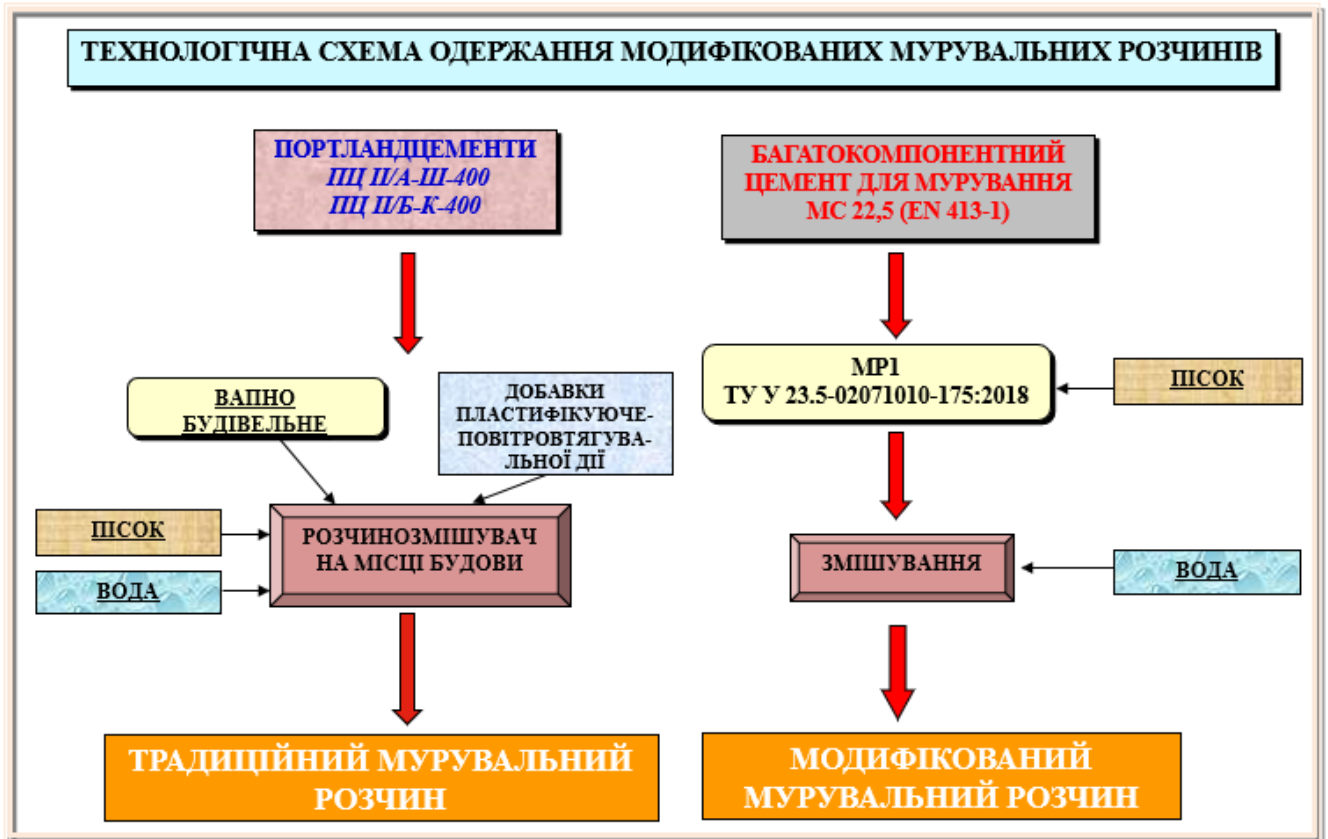
Рис. 5.5. Технологічна схема виготовлення модифікованих будівельних розчинів
