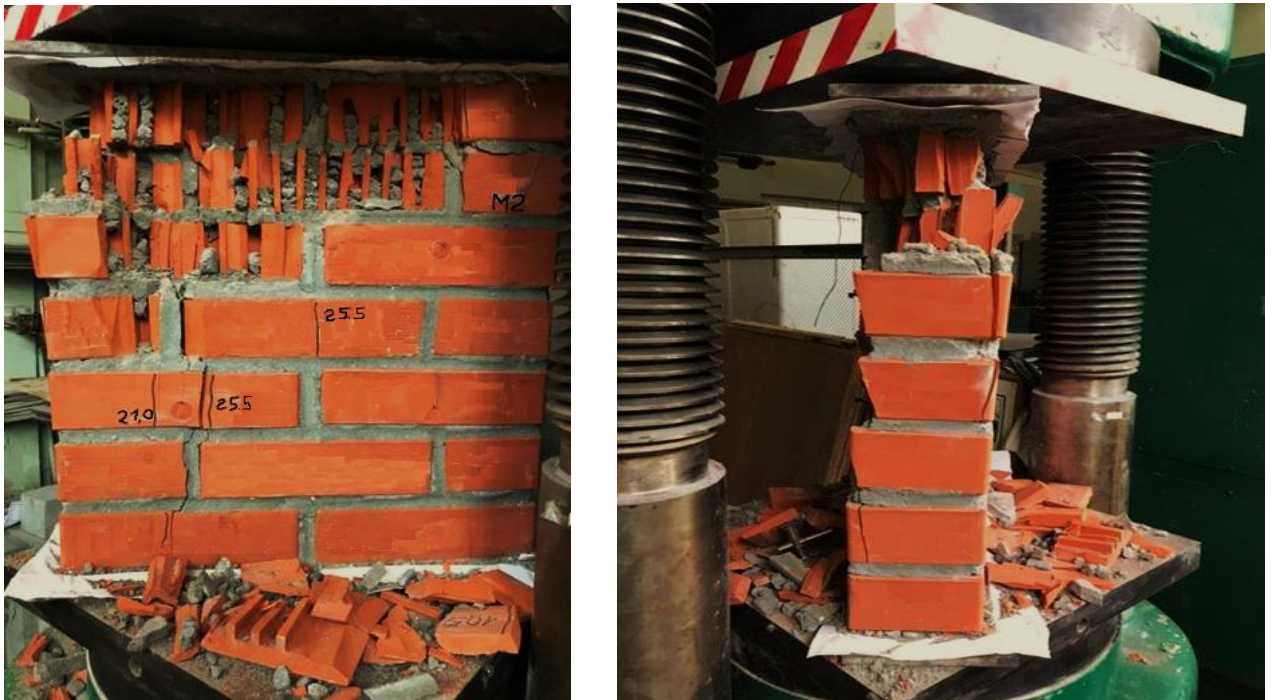
Рис. 4.20. Зруйнований зразок цегляної кладки після випробування
