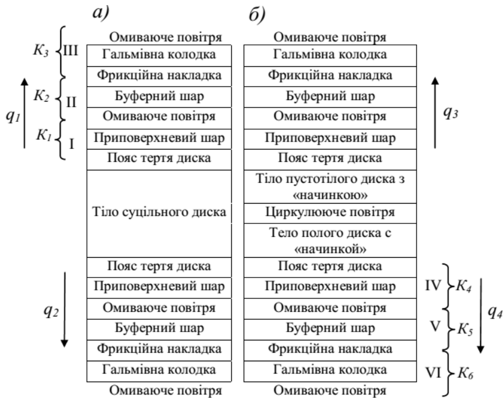
Рис. 8. Багатошарова теплова модель пари тертя дисково-колодкового гальма із суцільним (а) і вентиляваним (б) дисками: q_1, q_2, q_3, q_4 – теплові потоки; K_1, K_2, K_3, K_4, K_5, K_6 – коефіцієнти теплопередачі; I, II, III, IV, V, VI – нумерація шарів, що беруть участь у теплообміні
