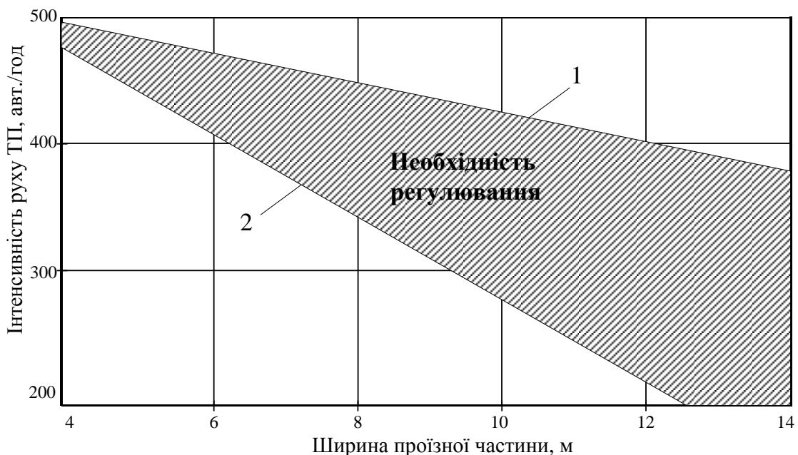
Рис. 1.2. Доцільність застосування світлофорної сигналізації за умови забезпечення безпечного переходу пішоходами ПЧ та мінімальної затримки ТЗ: 1 – за даними В. А. Владімірова; 2 – за даними М. С. Фішельсона
