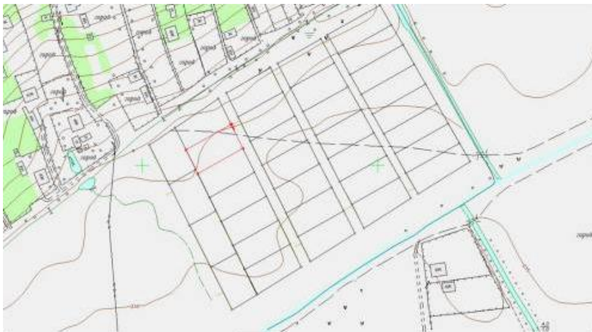
Рис. 2.9. Приклад збільшеного фрагменту дигіталізованого плану з нанесеним кварталом забудови.
