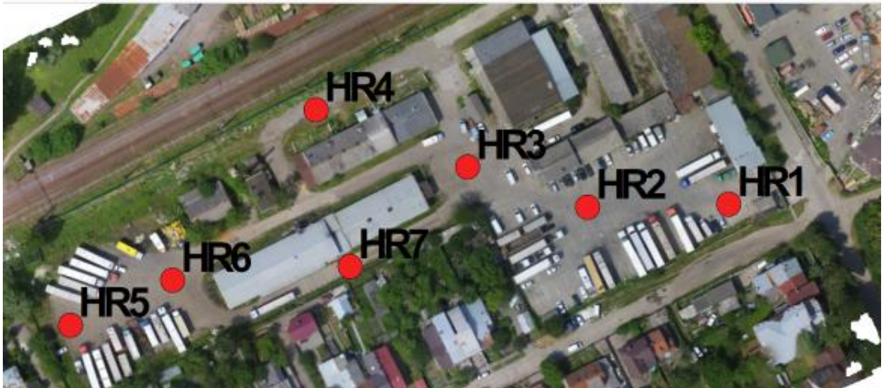
Рис. 2.6. Фрагмент ортофотоплану з планово-висотною основою.
