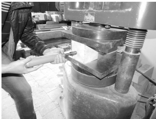
Рис. 3. Процес випробування взірця-куба методом пластичних деформацій
