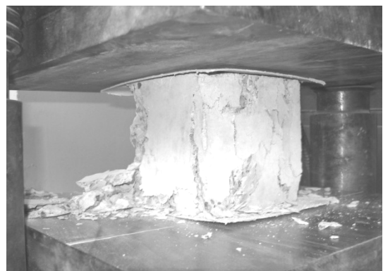
Рис. 4. Процес випробування еталонних взірців-кубів на стиск та загальний вигляд випробуваного взірця
