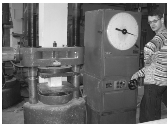
Рис. 4. Процес випробування еталонних взірців-кубів на стиск та загальний вигляд випробуваного взірця
