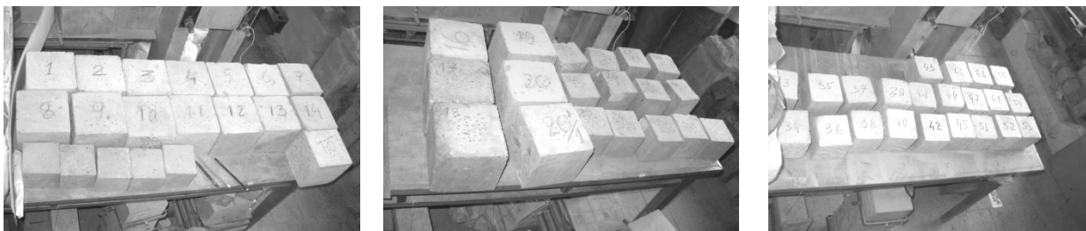
Рис. 6. Взірці-куби: розміром 150 × 150 × 150 мм (21шт.) та розміром 100 × 100 × 100 мм (32 шт.), які були використані для побудови градувальних залежностей
