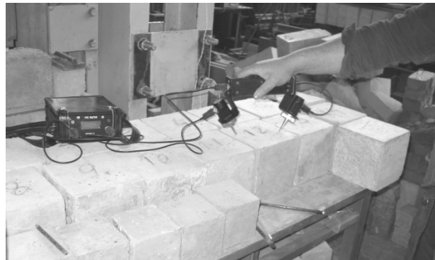
Рис. 2. Схема та загальний вигляд поверхневого прозвучування взірця-куба
