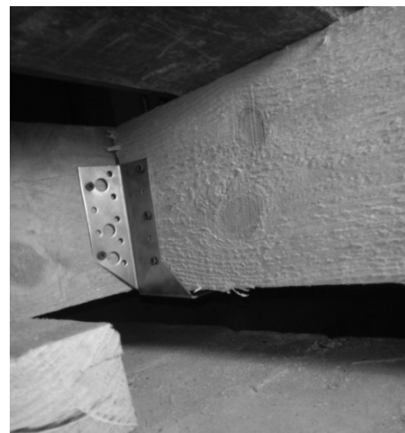
Рис. 2. Загальна схема випробувань: 1 – головна балка, 2 – другорядна балка, 3 – пластина-підвіс, 4 – нагелі, 5 – місце прикладення навантаження
