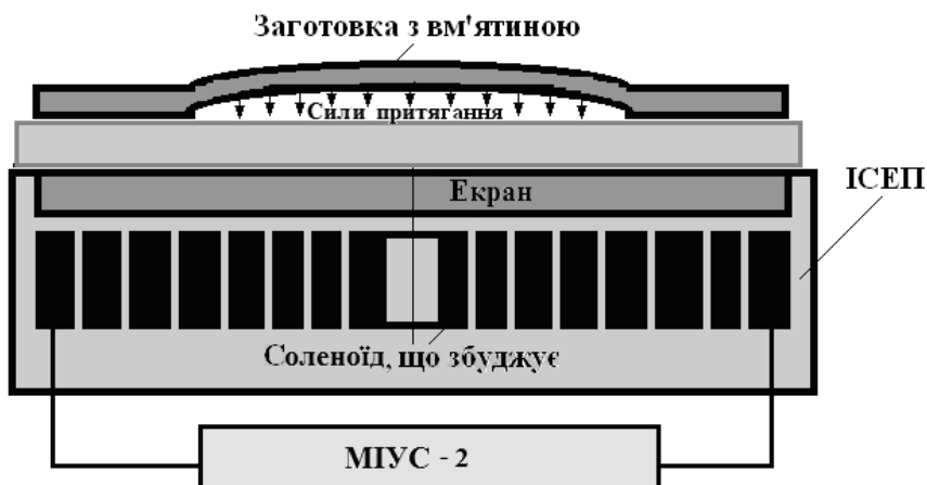
Рис. 3. Схема здійснення експериментальної операції з видалення вм'ятин у листових металах
