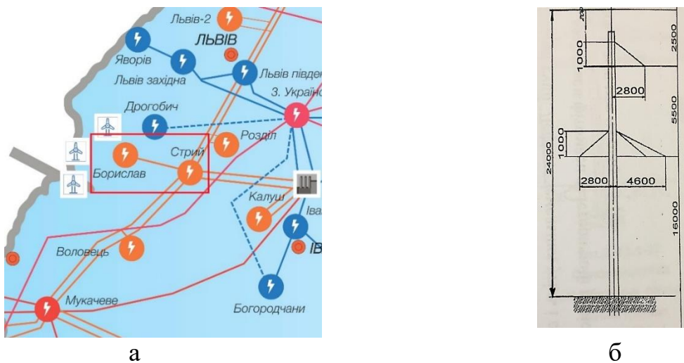
Рисунок 4.6 - Фрагмент схеми магістральних мереж ОЕС (а); ескіз проміжної опори типу ПБ-220-1 (б)
