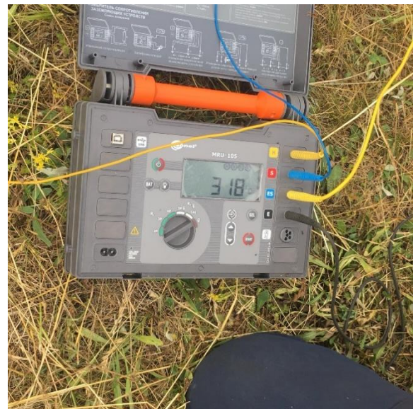
Рисунок А.6 Калібрування відстаней електродів та вимірювання питомого опору ґрунту
