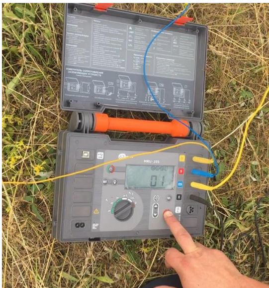
Рисунок А.6 Калібрування відстаней електродів та вимірювання питомого опору ґрунту
