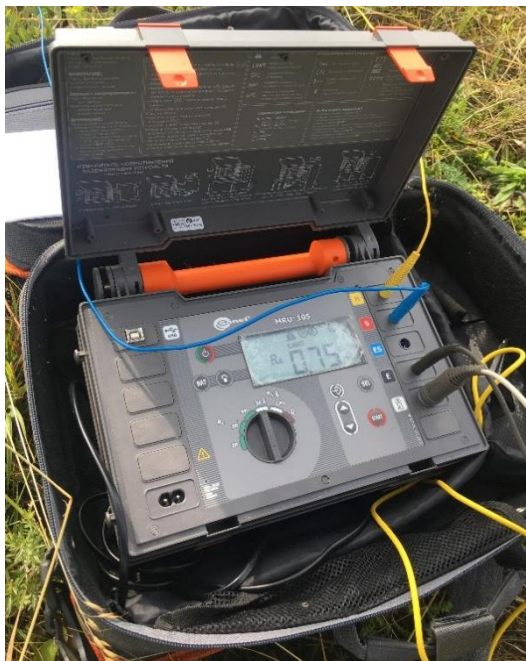
Рисунок А.4 Результати вимірювання опору заземлення спуску №1 та №2
