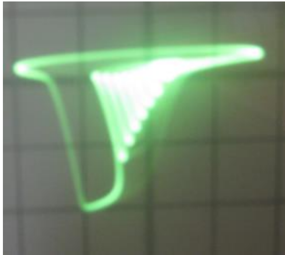
Рисунок 5.22 – Експериментальний фазовий портрет генератора детермінованого хаосу на біполярній ТСВО із від'ємною полярністю напруги живлення
