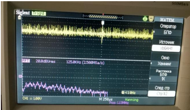
Рис. 22. Осцилограма та АЧС хаотичних коливань генератора на рис. 25,а
