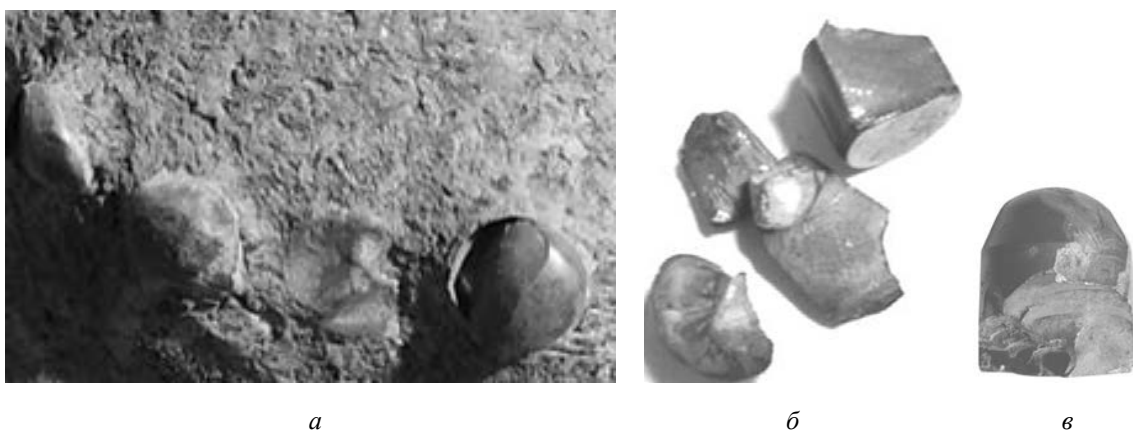
Рис. 2. Види катастрофічного розколювання твердосплавних зубків: а – розколювання робочої поверхні твердосплавних зубків; б – фрагменти розколених вздовж осі твердосплавних зубків; в – розколювання у нижній ділянці хвостовика твердосплавного зубка
