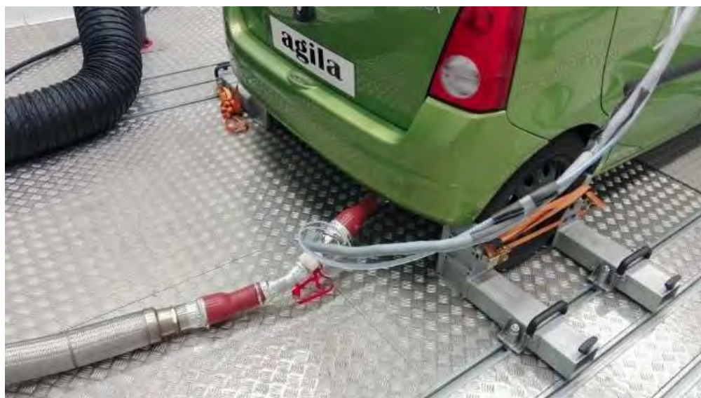
Rys. 2. Sonda pomiarowa systemu PEMS podłączona do wylotu spalin badanego pojazdu na hamowni podwoziowej
