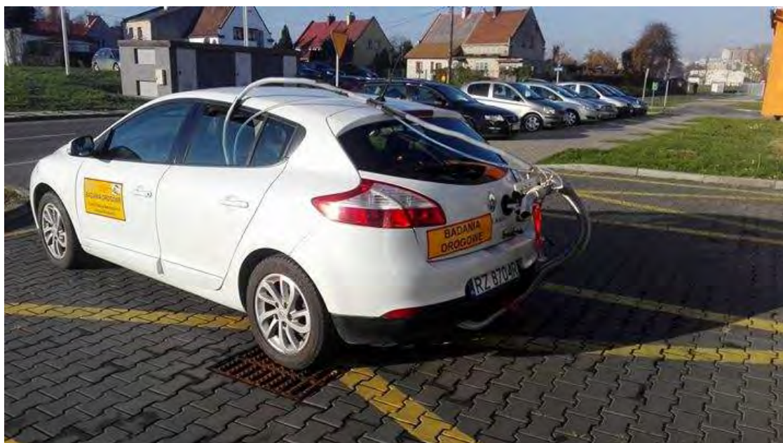
Rys. 3. Wybrany pojazd badawczy do prób RDE z zabudowanym systemem HORIBA OBS 2200
