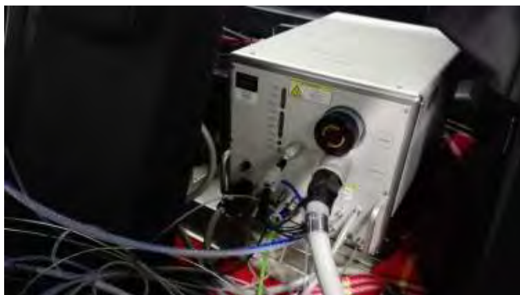
Rys. 1. System PEMS – Horiba OBS-2200, zainstalowany w części bagażowej badanego pojazdu
