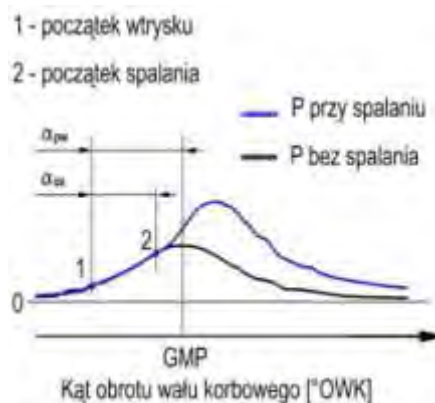
Rys. 2. Graficzne przedstawienie metody bezpośredniego porównania ciśnień w cylindrze: \alpha_{pw} – kąt wyprzedzenia wtrysku paliwa, \alpha_{os} – kąt opóźnienia samozapłonu
