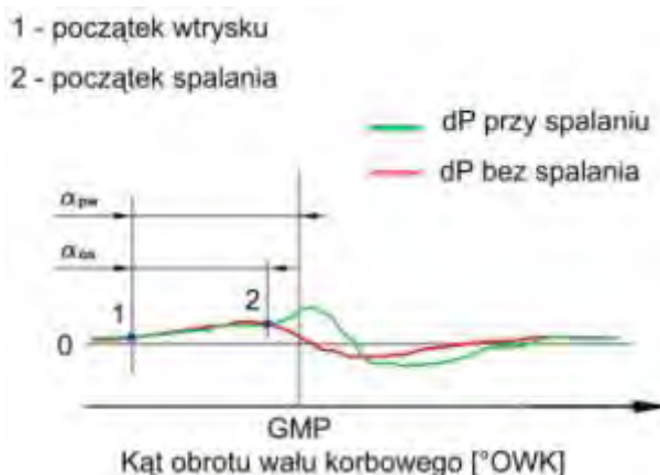
Rys. 3. Graficzne przedstawienie metody wyznaczania opóźnienia samozapłonu na podstawie przebiegu wartości pierwszej pochodnej ciśnienia w cylindrze: \alpha_{pw} – kąt wyprzedzenia wtrysku paliwa, \alpha_{os} – kąt opóźnienia samozapłonu
