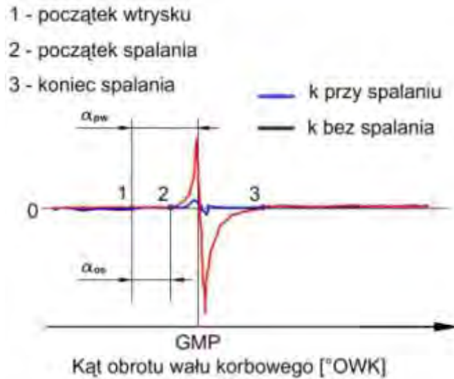
Rys. 5. Graficzna interpretacja wyznaczania parametrów procesu spalania z wykorzystaniem metody wykładnika politropy k : \alpha_{pw} – kąt wyprzedzenia wtrysku paliwa, \alpha_{os} – kąt opóźnienia samozapłonu
