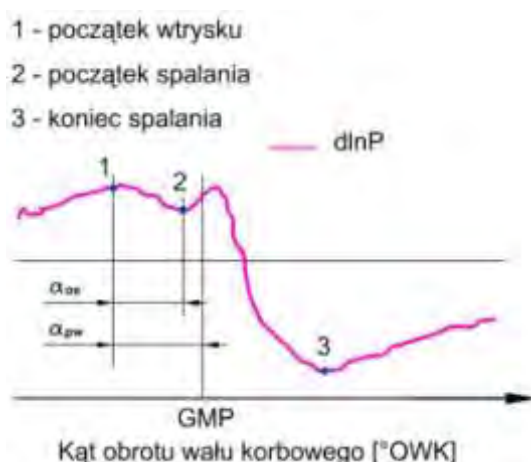
Rys. 4. Graficzna interpretacja wyznaczania parametrów procesu spalania na podstawie przebiegów pochodnej logarytmicznej zmiany ciśnienia w cylindrze silnika: \alpha_{pw} – kąt wyprzedzenia wtrysku paliwa, \alpha_{os} – kąt opóźnienia samozapłonu
