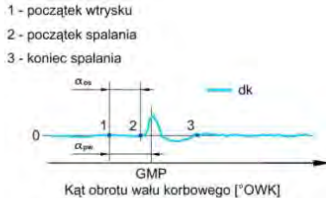
Rys. 6. Ilustracja metody oceny parametrów procesu spalania z wykorzystaniem wartości pierwszej pochodnej wykładnika politropy dk : \alpha_{pw} – kąt wyprzedzenia wtrysku paliwa, \alpha_{os} – kąt opóźnienia samozapłonu
