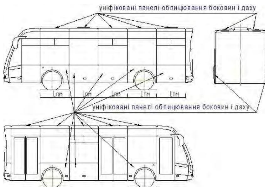
Рис. 1 – Схема уніфікації панелей зовнішнього облицювання боковин і даху кузова автобуса
