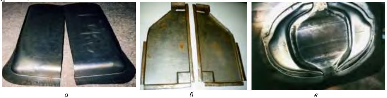
Рис. 7 - Приклади виготовлених деталей: а – панель задньої частини даху кузова автобуса «Еталон», б - арка бокова (габаритні розміри деталі 588×250 мм); в - арка зовнішня ВАЗ-2101
