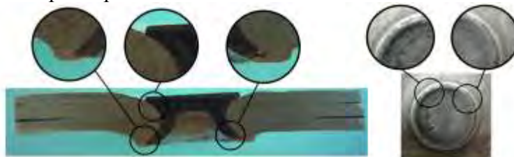
Рис. 5. Результати клепання пакету з трьох листів АМг2 ( V_{обж} = 23,6 м / с, E_{обж} = 39,0 Дж)
