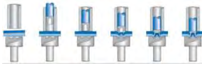
Рис. 2. Принципова схема утворення з'єднання за допомогою саморіжучих заклепок
