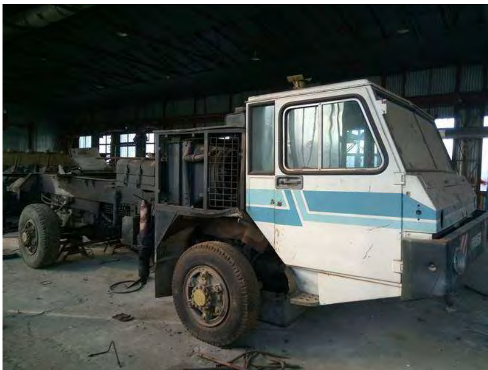
Рис.3 - Повнопривідне високоманеврене колісне шасі
