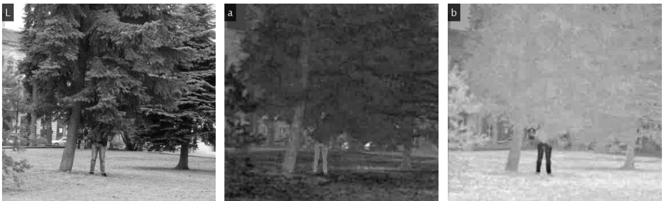
Рис. 3.15. Канали вхідного кольорового зображення (попередньо пронормовані) в Lab просторі
