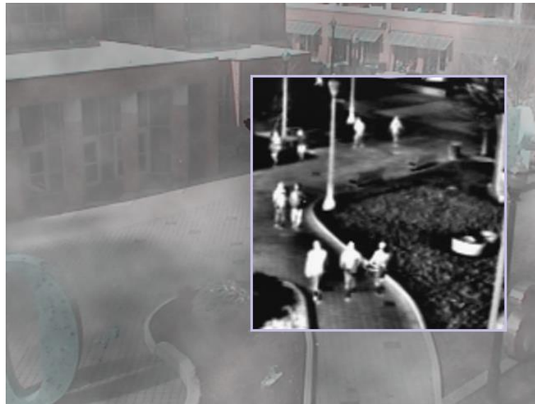
Рис. 2.5. Результат суміщення зображень A та B при погіршеній видимості в видимому діапазоні
