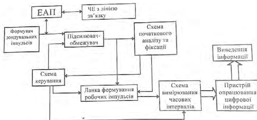
Рис. 4. Спрощена структурна схема багатозонного імпульсного термометра
