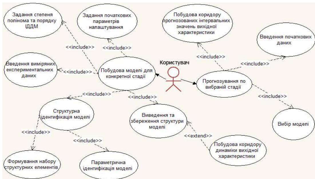
Рисунок 3.4 – Функціональна модель розроблюваного програмного комплексу для моделювання процесу анаеробного мікробіологічного бродіння на всіх його стадіях
