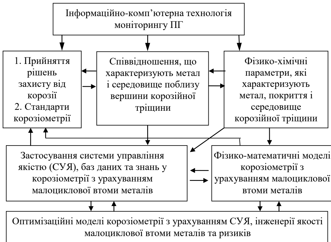
Рисунок 4.8. Структурна схема інформаційно-комп'ютерної технології для ПГ з урахуванням корозійних процесів
