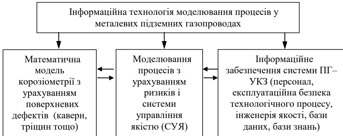
Рисунок 3 – Структурна схема інформаційної технології для моделювання процесів у підземних газопроводах
