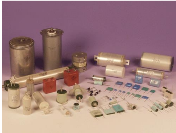
Рис. 1.6. Типи конденсаторів з вузлом вологозахисту та прохідним виводом
