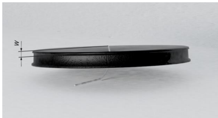
Рис. 3.8. Фотографія деформованого стану системи "текстолітова перегородка-компаунд"
