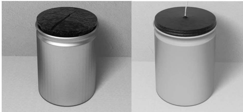
Рис. 3.9. Приклади дефектів розтріскування (а) та виштовхування (б) конденсаторів при їх розгерметизації під дією надлишкового внутрішнього тиску розігрітого повітря
