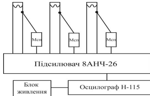
Рис. 5.10. Блок-схема підключення тензорезисторів до тензовиміральної апаратури
