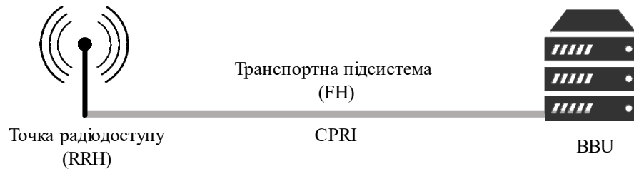
Рис. 4.15. Компоненти затримки в C-RAN
