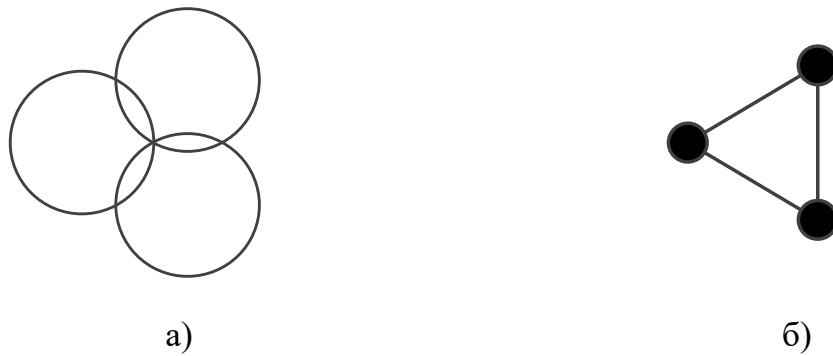
Рис. 2.6. Модель коміркової структури мережі з моносекторними комірками: а) ідеальна; б) граф структурної моделі мережі без урахуванням перекриття несуміжних секторів; в) граф з урахуванням перекриття несуміжних секторів
