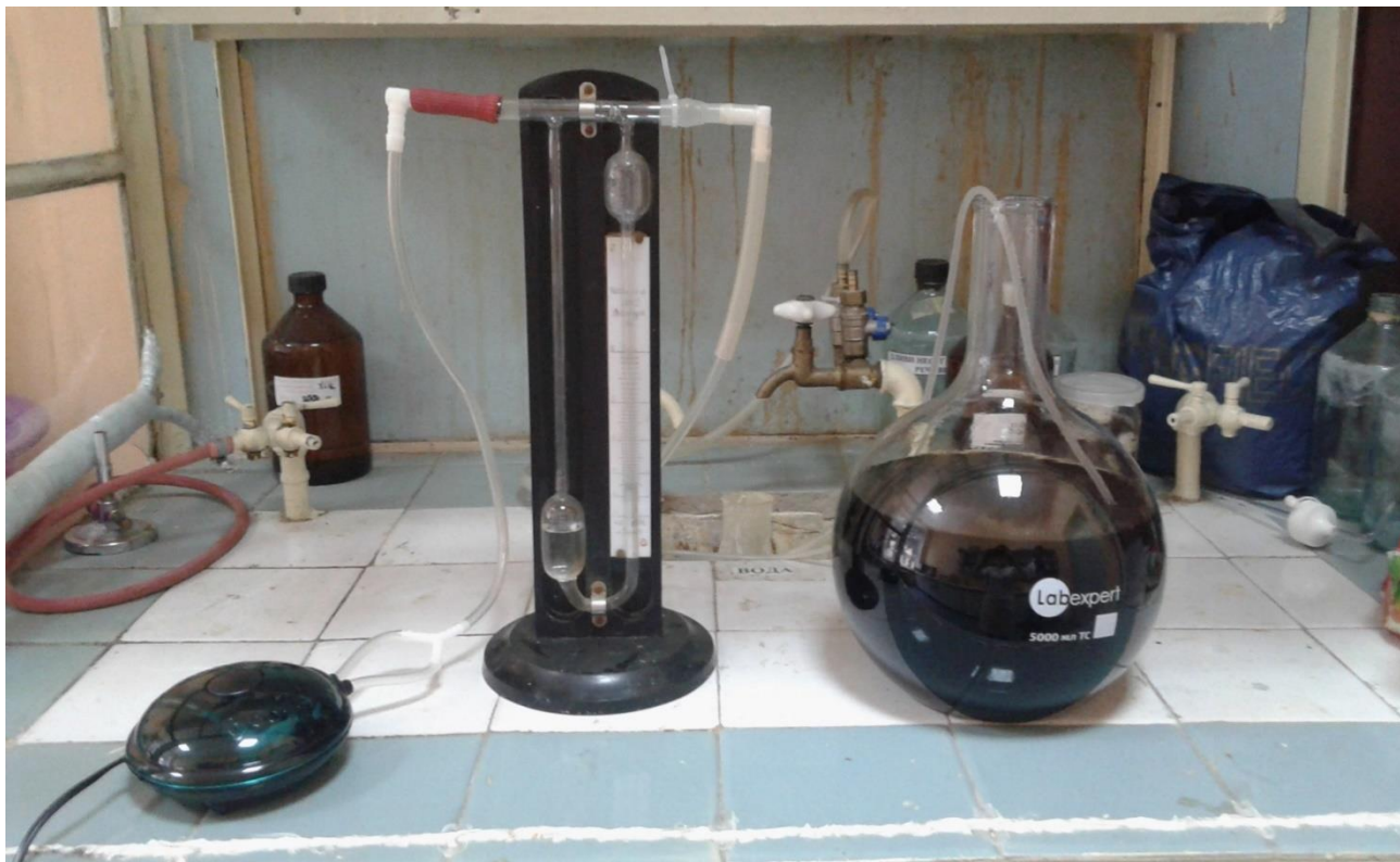
Рисунок 2.6 Експериментальної установки для дослідження аеробного очищення інфільтрату.
