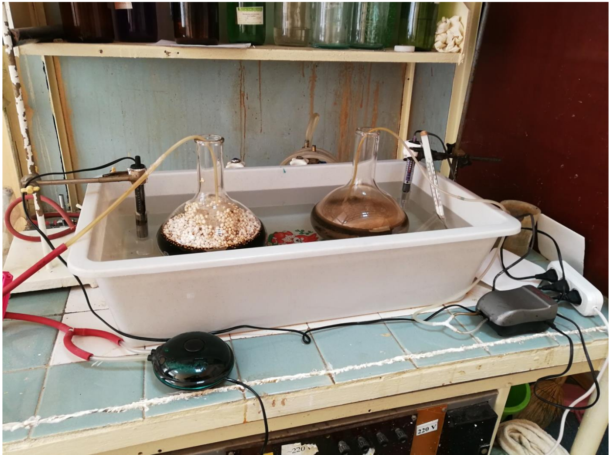
Рисунок 4.10 - Загальний вигляд дослідної установки дослідження залежності ефективності очищення інфільтрату від внесення в систему насадкових тіл для іммобілізації на них біоценозу.
