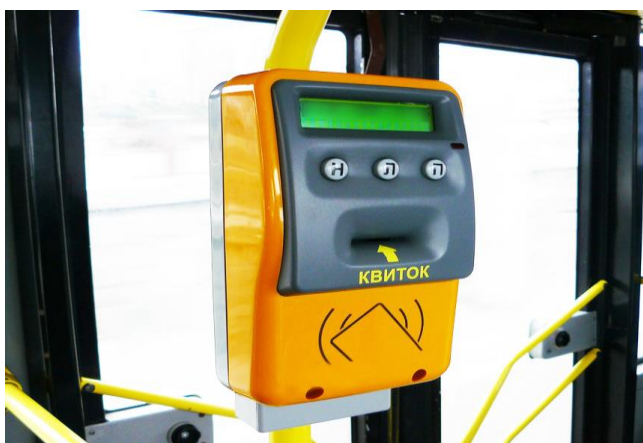
Рисунок 1.2 – Приклад валідатора для системи “електронний квиток” [39]
