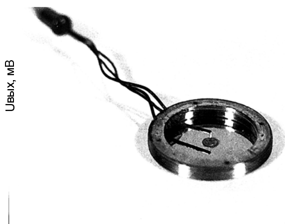
Рис. 9. Сенсор для вимірювання малих перепадів тиску криогенних рідин
